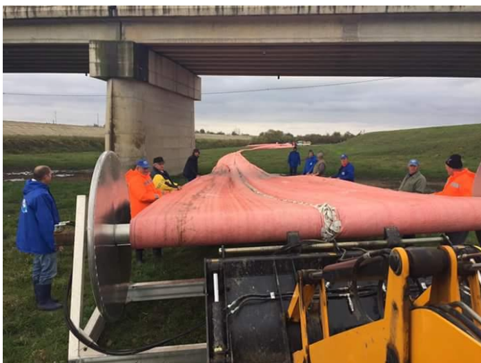
Masina de umplut saci cu nisip (instalatie de mare capacitate pentru alimentarea automata a sacilor cu nisip)
